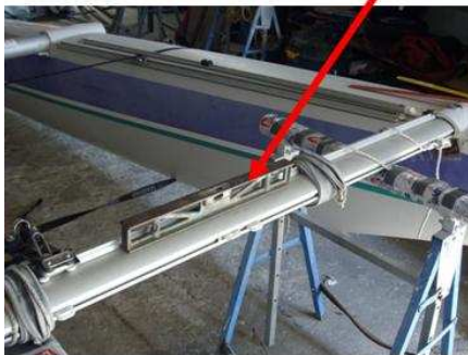
Utilizar um nível de bolha
